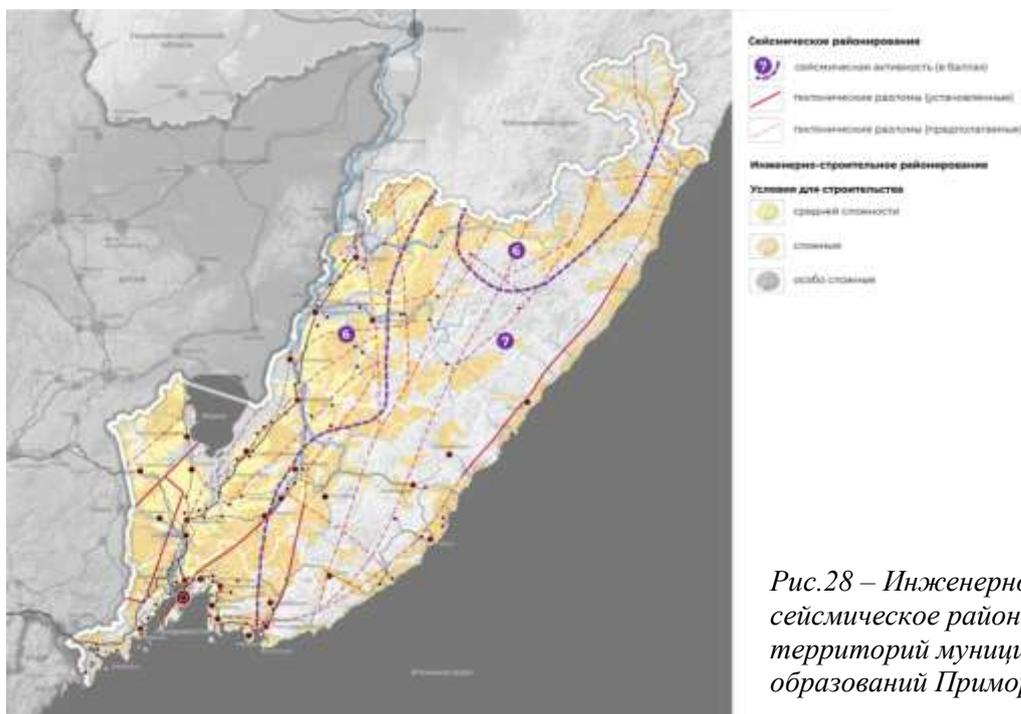
Рис.28 – Инженерно-строительное и сейсмическое районирование территорий муниципальных образований Приморского края
